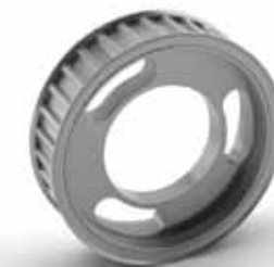
Eindrehung und Langlöcher zur Massereduzierung und Positionsausrichtung
