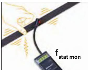
Tato metoda způsobí zvýšené zatížení ložisek během několika prvních hodin provozu.
