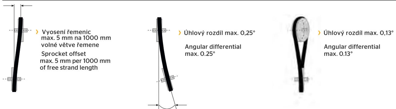
Součet všech úhlových chyb nesmí překročit 0,25° mezi jednotlivými větvemi.
