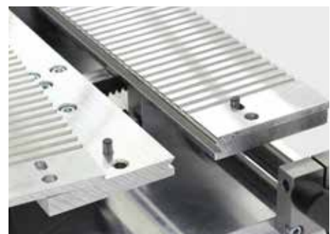
Arretierungsstifte sorgen für die richtige Positionierung der Adapterplatten auf dem Fügetisch.
