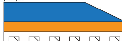
MF řemen s PU ozubením pro synchronní pohyb.
